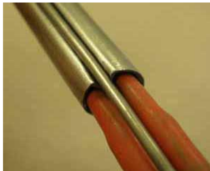
Seitliche Nut mit eingelegtem Thermoelement
