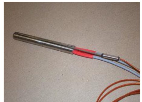
Seitliche Nut mit eingelegtem Thermoelement
