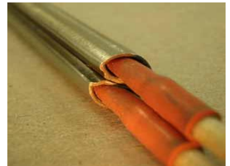
Seitliche Nut ohne Thermoelement
